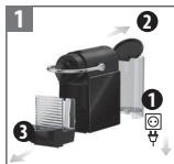
Odpojte kávovar ze sítě a vyjměte nádobu na vodu i kontejner na použité kapsle.
