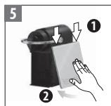
Coloque los nuevos paneles laterales como se muestra en la imagen. Asegúrese de que el panel está fijado correctamente.
