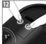
Aby wyjść z trybu odkamieniania, wcisnąć jednocześnie oba przyciski na jedną sekundę. Urządzenie jest gotowe do użytku.
