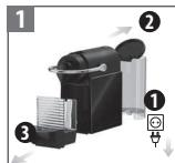
Αποσυνδέστε τη μηχανή και αφαιρέστε το δοχείο νερού.
