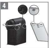
Positionieren Sie das neue Seitenpanel, die Pfeile zeigen nach oben.
