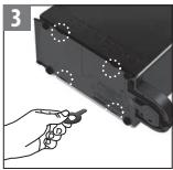
Do odłączania paneli użyj specjalnego klucza Nespresso w czterech otworach w podstawie.
