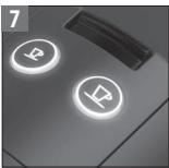
**i** Drücken Sie die Espresso- (40 ml) oder Lungotaste (110 ml). Die Zubereitung stoppt automatisch. Um den Wasserfluss zu stoppen oder um Kaffee aufzufüllen, drücken Sie die Taste nochmals.
