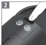
Zapněte přístroj. Pokud tlačítka pro přípravu kávy blikají, přístroj se nahřívá (cca 25 vteřin). Pokud tlačítka svítí, přístroj je připraven k použití.
