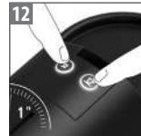
Para salir del modo de descalcificación, pulse los dos botones simultáneamente durante 1 segundo. La máquina está preparada para su uso.
