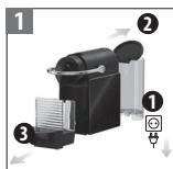
Ziehen Sie den Netzstecker und entfernen Sie den Wassertank und die Wartungseinheit.
