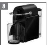
Umísteňte nádobu na vodu pod výpust kávy a stiskněte tlačítko Lungo pro propláchnutí přístroje. Opakujte třikrát.
