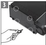
Utilice la llave Nespresso en los cuatro orificios para desmontar los paneles.
