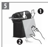
Befestigen sie das neue Seitenpaneel wie auf dem Bild dargestellt. Stellen Sie sicher, dass das Paneel ordnungsgemäß befestigt ist.
