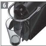
Für die Verwendung eines Latte Macchiato Glases bringen Sie das Abtropfgitter in die aufrechte Position. Es fällt automatisch wieder herunter, wenn Sie das Glas entfernen, damit ein Nachtropfen auf Arbeitsoberflächen vermieden wird.
