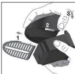
Για να συναρμολογήσετε τη βάση κουπών και τον δίσκο αποστράγγισης: αφαιρέστε το πλέγμα, τοποθετείστε τα δύο τηήματα το ένα δίπλα στο άλλο, κι έπειτα συνδέστε τον δίσκο αποστράγγισης με τη βάση κουπών.
