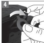
Entfernen Sie das Paneel, indem Sie den Nespresso-Key wie im Bild dargestellt drehen.
