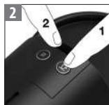
Przytrzymać i przytrzymać przycisk Lungo i włączyć urządzenie.
